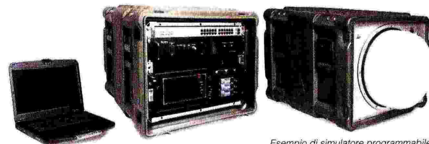
Esempio di simulatore programmabile di RADAR/SEEKER per la validazione dei sistemi di contromisure elettroniche delle unità navali militari
